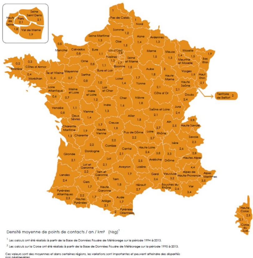
Figure 38 : Carte de la densité de foudroiement de la France issue de la norme NFC 17-102 (05-2015)
